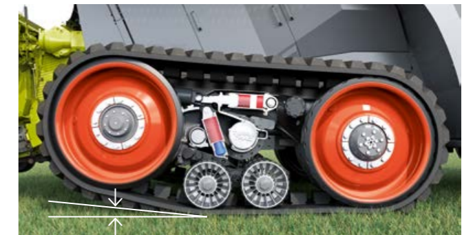
66% contactoppervlak: het loopwiel wordt tot 100 mm opgeheven.
