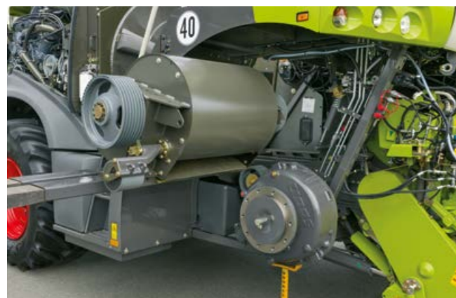
Eenvoudig in- en uitbouwen van de uitwerpversneller
