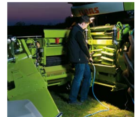
QUICK ACCESS maakt inspectie van de hakseltrommel in slechts enkele minuten mogelijk.
