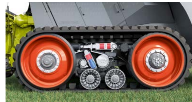
100% contactoppervlak: het loopwiel heeft volledig contact met de bodem.
