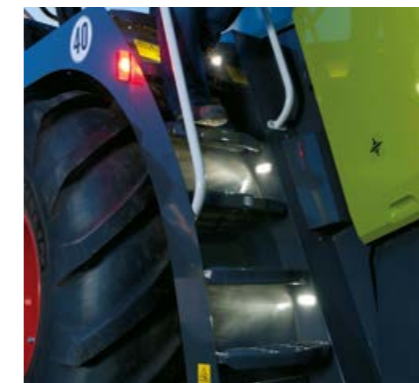
Led-verlichting bij de trap voor veilige toegang tot de comfortcabine.
